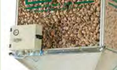
transparenter Behälter - Füllstand leicht sichtbar
