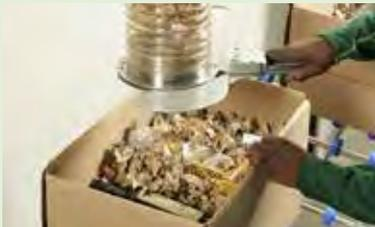
Die ergonomisch geformte Abfüllzange ermöglicht ermüdungsfreies Verfüllen.
