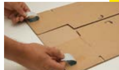
Silikonabdeckband an der vorderen Lasche abziehen
